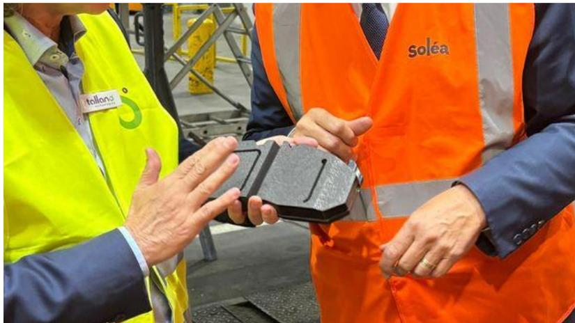
Une plaquette de frein, avec des rainures pour évacuer les particules de freinage © Radio France - Dimitri Morgado
